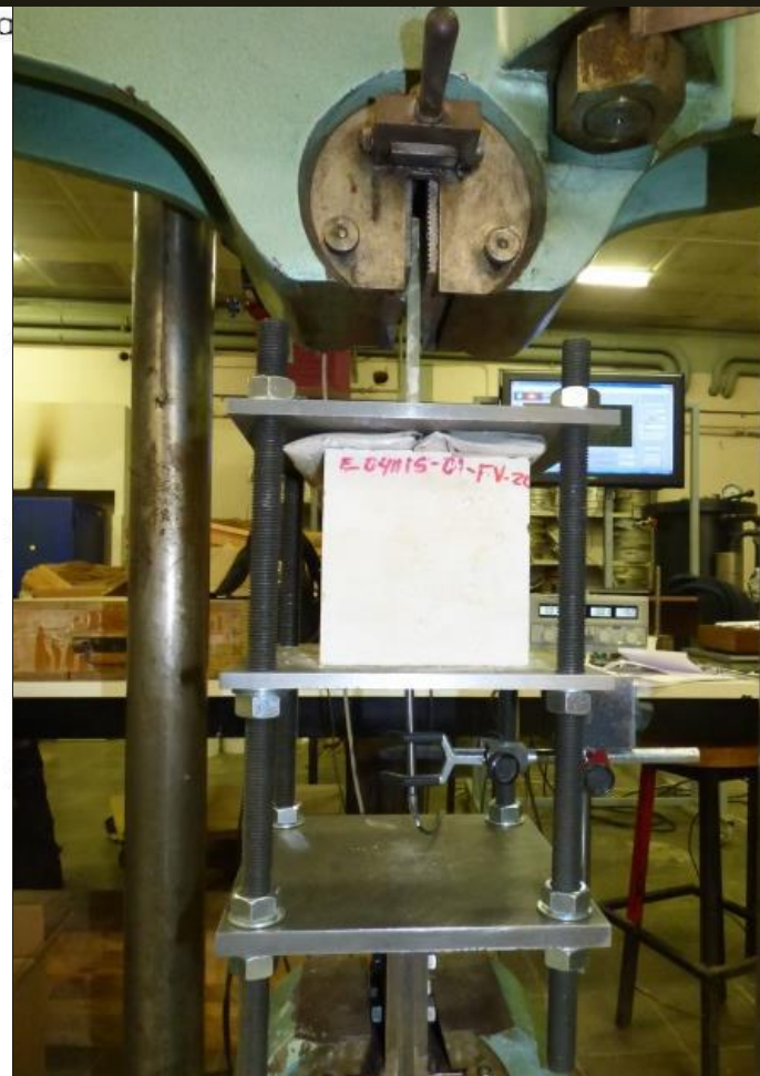
Esquema del útil para el ensayo “pull out” y probeta 15x15x15 cm durante el ensayo UNE EN 10080
